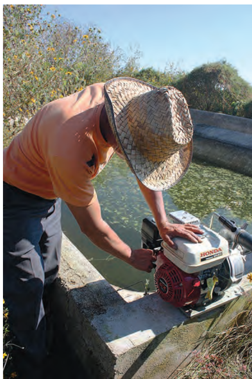
Foto 119. Bomba portátil usada para dar presión al agua de riego. Tetela del Volcán, Tetela del Volcán. 2011.
