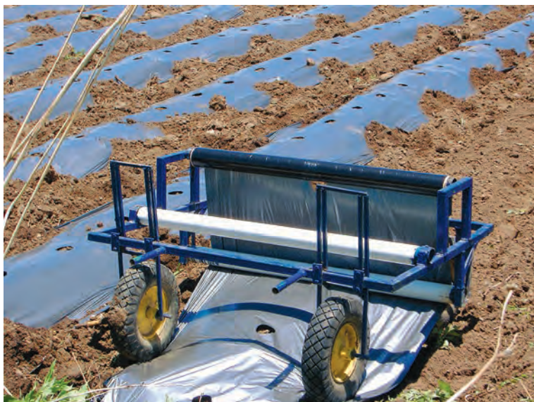
Foto 48. Máquina, invento local para la colocación de acolchados. Totolapan, Totolapan. 2010.
