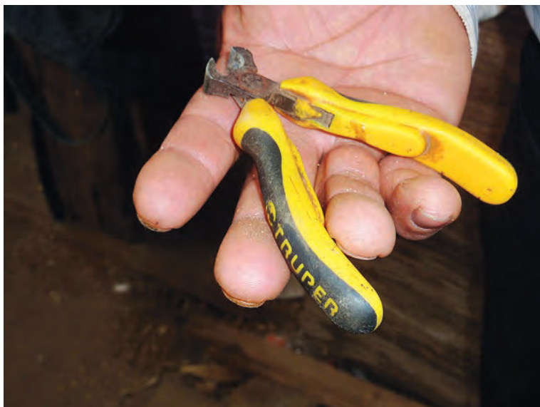
Foto 91. Pinzas para descabezar granos de maíz pozolero. Achichipico, Yecapixtla. 2017.
