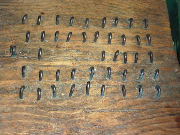
Foto 88. Tabla con clavos, construida especialmente para desgranar. Achichipico, Yecapixtla. 2017.
